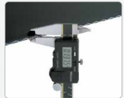
Mida el espesor de la banda.
