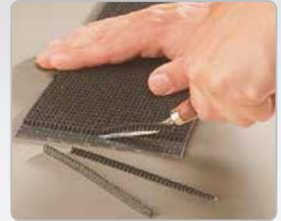
Desbaste la cubierta de impresión.
