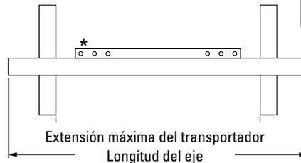
\*El tamaño de cada eje se puede utilizar con una hoja del tamaño del ancho de una banda con menos 50 mm o ancho de banda con menos 200 mm
