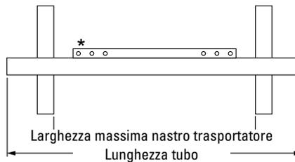
\*Ogni dimensione tubo può essere usata con una lama di misura corrispondente alla larghezza nastro meno 50 mm, meno 200 mm o meno 350 mm
