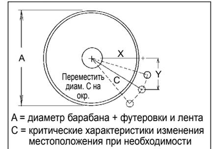
A = диаметр барабана + футеровки и лента
