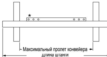
\*Каждый размер штанги можно применять с размером лезвия, равным ширине ленты минус 50 мм, ширине ленты минус 200 мм или ширине ленты минус 350 мм
