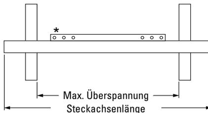
\* Jede Steckachsengröße kann mit einer Blattgröße von Bandbreite minus 50 mm, minus 200 mm oder minus 350 mm kombiniert werden
