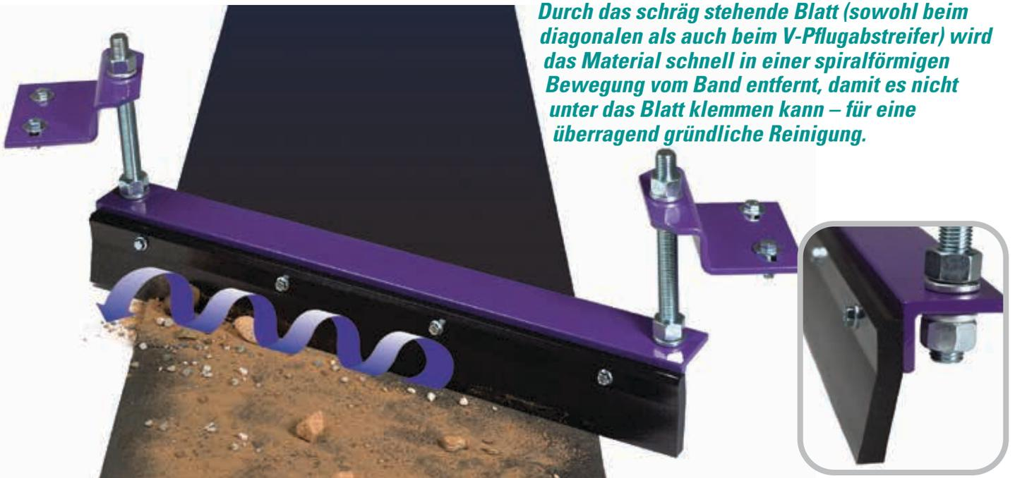
**Durch das schräg stehende Blatt (sowohl beim diagonalen als auch beim V-Pflugabstreifer) wird das Material schnell in einer spiralförmigen Bewegung vom Band entfernt, damit es nicht unter das Blatt klemmen kann – für eine überragend gründliche Reinigung.**
