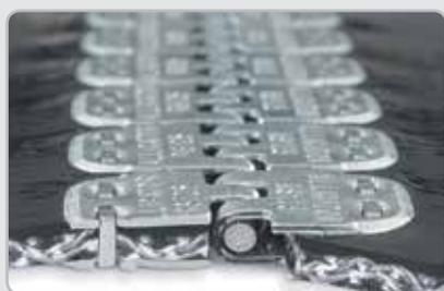
Progettato per nastri trasportatori strutturati per servizio leggero e medio, il dispositivo di fissaggio Alligator® Staple usa un fissaggio punti in acciaio inox a elevata resistenza alla trazione combinato con un design a piastra allungata. Questo design separa il punto di penetrazione del dispositivo di fissaggio dalla linea di flessione del nastro, eliminando le sollecitazioni sul punto di attacco del nastro.
