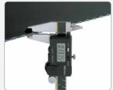
Mida el espesor de la banda.
