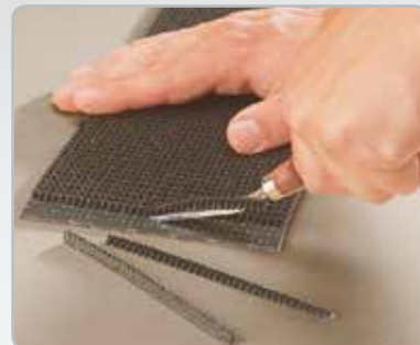
Desbaste la cubierta de impresión
