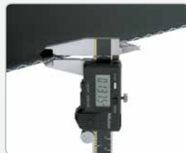
Mida el espesor de la banda.
