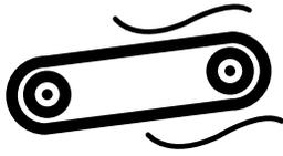
**DAS PROBLEM:** Festgefressene Umlenkrollen, nicht rechtwinklige Bandverbindungen, gebogene Förderbandstrukturen und Materialansammlungen führen zu einem Fehllauf des Förderbands. So kommt es zu Gurtschäden, außermittiger Belastung und Materialüberlauf in der Ladezone und über die gesamte Länge des Förderbandes.
