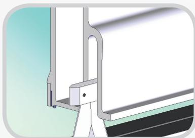
*La parte superiore della lama è incorporata nella parte estrusa, in modo da garantire la realizzazione di un taglio perpendicolare.*
