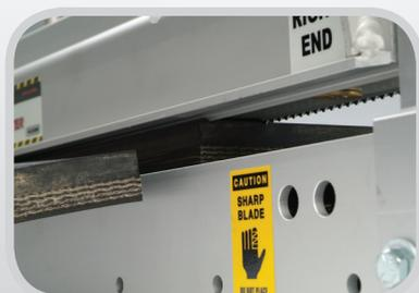
*La traversa inferiore curva e la superficie di presa leggermente seghettata forniscono la massima forza di tenuta, consentendo alla lama di tagliare il nastro con la massima precisione.*
