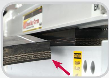
*L'esclusiva morsa laterale consente al nastro tagliato di cadere liberamente da un lato, eliminando la necessità di impiegare la lama per tagliare tra due superfici serrate e riducendo lo sforzo dell'operatore.*
