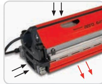
**Enfriamiento de aire integrado:** los ventiladores de enfriamiento están colocados en las varillas superior e inferior, lo que reduce el tiempo de enfriamiento después de completar el empalme. Puede esperar un **tiempo de empalme promedio de 8 a 12 minutos.**
