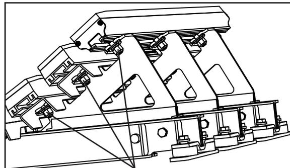
Abb. 9 Flache Unterlegscheiben, Sicherungsscheiben und selbstsichernde Muttern
