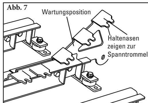
8. **Prallbalken montieren.** Mit den mittleren beginnend alle Prallbalken korrekt einsetzen. Die Stehbolzen zwischen die Haltenasen in der Flügelplatte setzen und dabei darauf achten, dass das abgeschrägte Ende des Prallbalkens an der zur Spanntrommel zeigenden Seite des Prallbetts sitzt (Abb. 8).
