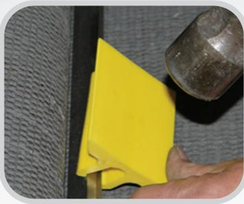
**Einfache Installation:** Installieren Sie das Hitch Guard (HG) mit einfachen Halterungen und Befestigungselementen, dann installieren Sie die einzelnen Segmente, indem Sie sie mit einem Gummihammer leicht einklopfen.
