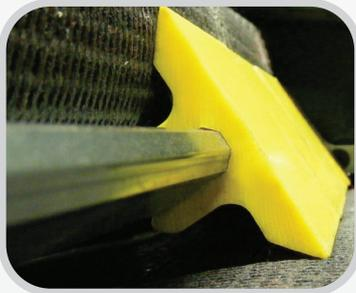
**Einrastmechanismus:** Die 3-Zoll-Segmente sind so ausgelegt, dass sie auf Druck nachgeben, wenn sich kleine Gegenstände zwischen dem Förderband und den Segmenten verfangen.
