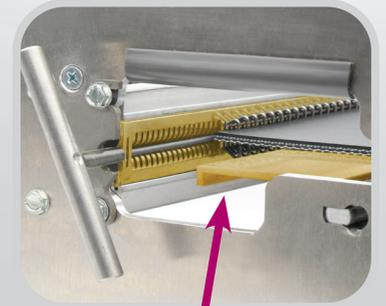
*El estante de soporte de la banda guía fácilmente la banda hacia las puntas del gancho, lo que reduce el tiempo y esfuerzo del operador. El sujetador de transporte está incluido para facilitar el transporte de la engrapadora al sitio de trabajo.*
