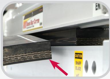
Односторонний зажим для свободного падения отрезанной части ленты с одной стороны. При этом исключается необходимость прохождения режущего лезвия через две сжатые поверхности, что уменьшает усилие, прикладываемое пользователем.
