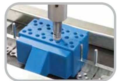
Montage mit Druckluft-Nietentreiber
