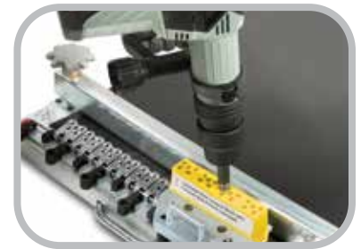
Montage mit elektrischem Nietentreiber
