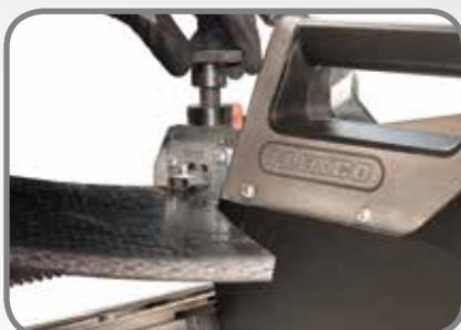
使用集成导板，可以更轻松地装载沉重的输送带。
