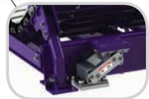
*Los amortiguadores de energía de impacto se comprimen hasta 3" (75 mm) para disipar las cantidades inmensas de energía de impacto.*
