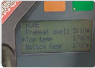
Capacidad para configurar **temperaturas independientes** de los elementos de calentamiento superiores e inferiores para garantizar un empalme óptimo.
