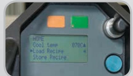
Cargue las recetas guardadas para asegurar uniformidad en el rendimiento de alta calidad del empalme, independientemente de qué técnico opere la prensa.
