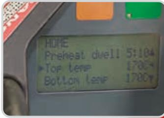
Erlaubt das Einstellen **unterschiedlicher Temperaturen** der oberen und unteren Heizelemente, um eine optimale Verbindung sicherzustellen.
