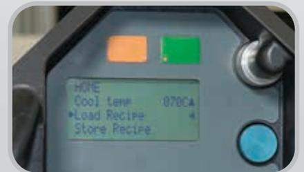
Laden gespeicherter Rezepte, um Verbindungen gleich bleibend hoher Qualität sicherzustellen, unabhängig von der Person, die die Heizpresse bedient.
