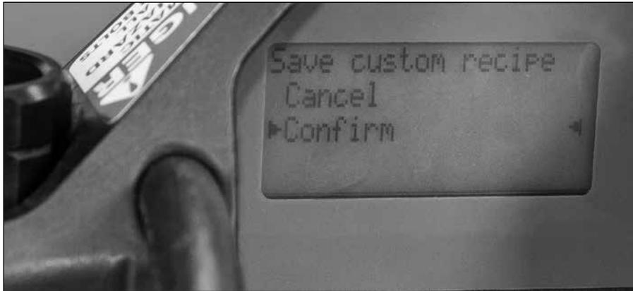
2. La pantalla muestra USB Device Detected (Se detectó un dispositivo USB) con opciones para seleccionar “Export Data Log” (Exportar registro de datos), “Import Recipes” (Importar recetas), “Export Recipes” (Exportar recetas) y “Back” (Regresar). Desplácese a “Import Recipes” (Importar recetas) y presione el botón selector. Seleccione “Cancel or Confirm” (Cancelar o Confirmar).
