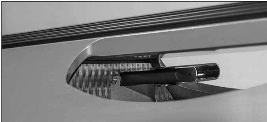
1. Siga las instrucciones para encender la prensa, luego inserte la memoria USB en el puerto USB en la parte superior de la prensa.
