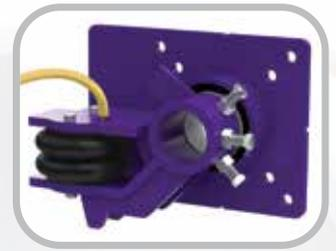
**Druckfeder:** Das Aufrechterhalten der richtigen Blattspannung ist der Schlüssel für optimale Lebensdauer und Reinigungsleistung. Die simple aber effektive Druckfeder-Konstruktion von Flexco erlaubt die Überprüfung und das Einstellen der Spannung zu jeder Zeit, ohne dass auf das Abschalten der Anlage gewartet werden muss. Flexco bietet auch andere Spannvorrichtungen an, wie z. B. mit Luft oder Stickstoff, die Leistungsoptionen der Oberklasse bieten.
