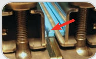
**Cortadora integrada:** El operador está protegido de la hoja durante el funcionamiento de corte de una sola pasada.
