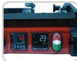
**Control digital de tiempo** con ajustes rápidos, simples de empalme; el **Ajuste de pre-calentamiento** se puede utilizar para eliminar la humedad y evitar los agujeros
