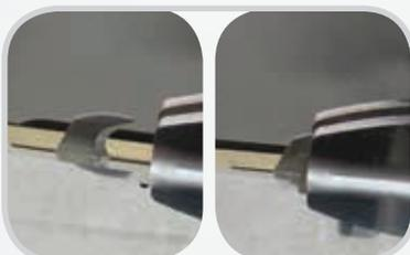
**Posición de almacenamiento de la cortadora:** La cortadora debe estar en la posición de almacenamiento para que la función de empalme opere.
