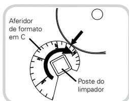
O gabarito especial facilita a definição da localização adequada de instalação para garantir o desempenho de limpeza ideal. Os quatro designs opcionais de suporte de montagem ajudam a simplificar instalações complexas
