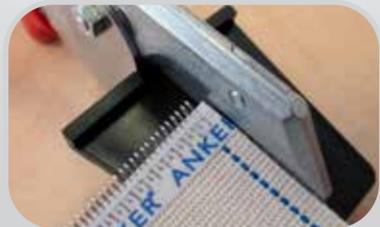
Las pinzas de cinta se pueden usar para cortar los extremos de la banda y las esquinas de las del parche de grapa instalado para evitar que los bordes queden atrapados durante la operación.
