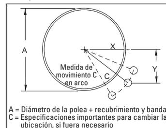
A = Diámetro de la polea + recubrimiento y banda
