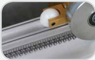
Clipper® 維護釘扣機 — 利用精確的 Roller Lacing Technology™ 快速現場安裝 G Series™ 釘扣
