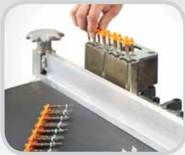
Sólo requiere una herramienta de instalación estándar de Flexco® MSRT, un ensamble del bloque de guía de acero y los remaches de Rapid Loader™ alineados con las arandelas.
