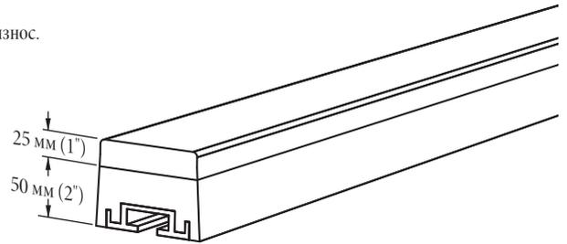
Амортизирующий брус с покрытием UHMW 25 мм (1")
