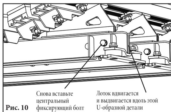
11. **Проверьте правильность зазора между желобом и лентой.** Высоту центрального натяжного ролика проверяйте по табл. 2. На станциях с полными брусками должен быть предусмотрен зазор 6 мм (1/4") для поднятия ленты (рис. 11). Если этот зазор установлен неправильно, отрегулируйте с помощью прокладок высоту натяжных роликов или станции соответственно.
