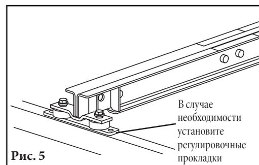
6. **Проверьте по угольнику все U-образные поперечины.** с помощью угольника проверьте, что первая U-образная поперечина перпендикулярна конструкции конвейера и надежно к ней прикручена. Затем расставьте оставшиеся U-образные поперечины, соблюдая правильный межцентровый интервал. Применяйте язычки на предусмотренном креплении, чтобы задать этот интервал (рис. 6а). Если это невозможно, используйте размеры, приведенные в табл. 3 (рис. 6б). Затяните все болты на месте.
