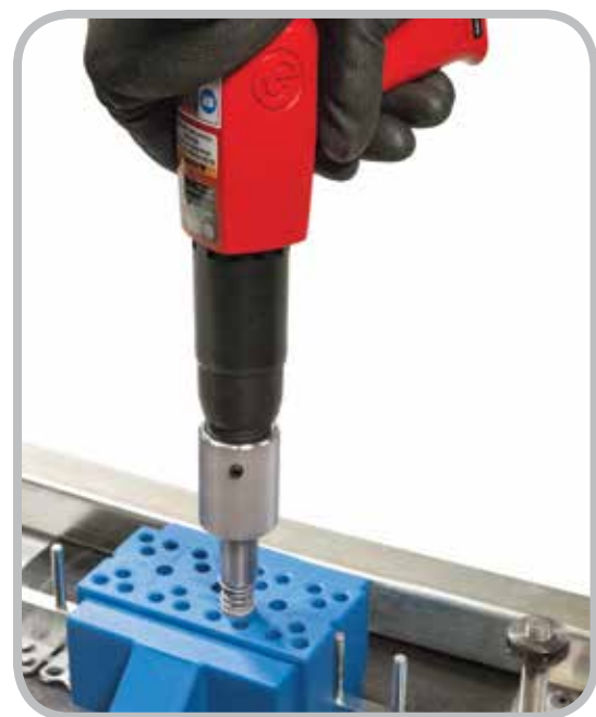
Instalación de la herramienta de Instalación de remaches neumática
