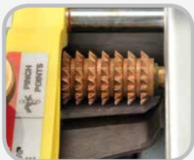
*Cilindros de acionamento frontal prendem a correia para impedir o deslizamento.*
