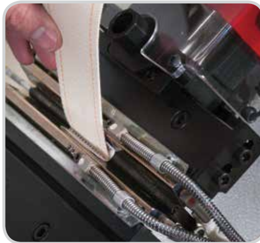
内置冷却系统 确保贴签材料与洗 涤带正确粘合
