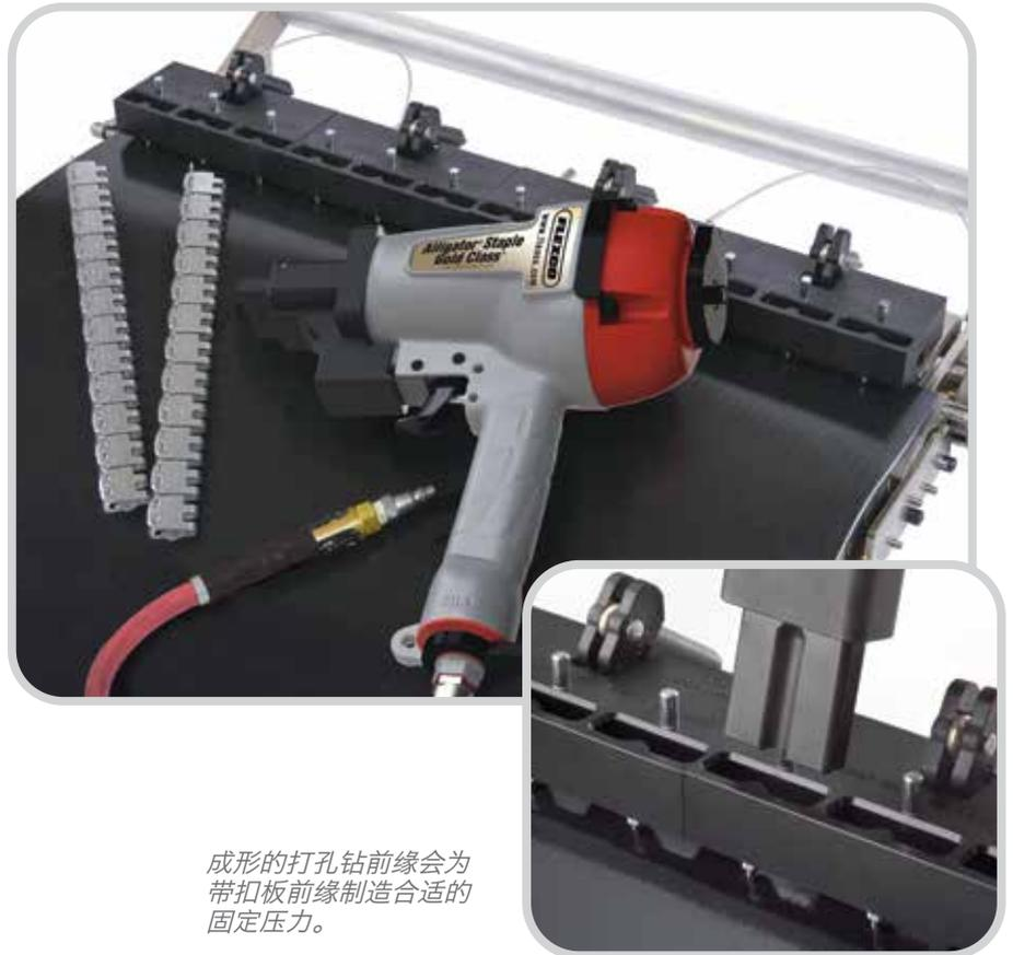
成形的打孔钻前缘会为带扣板前缘制造合适的固定压力。
