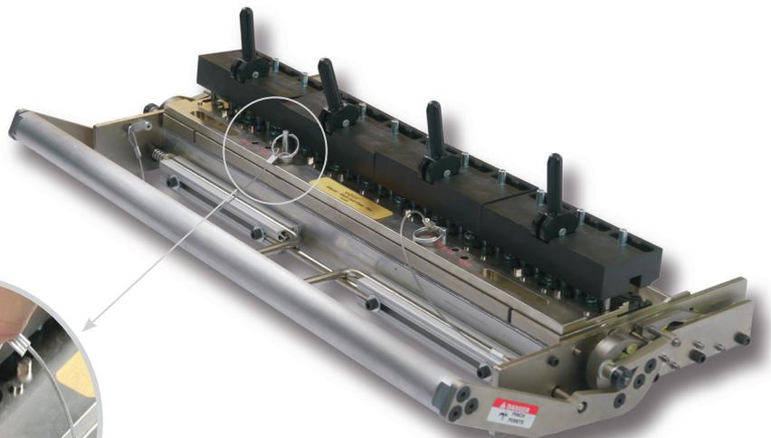
Das schnelle Wechseln der Verbindergrößen wird durch das einzigartige Kammdesign des Gold Class™ Plus erreicht.
