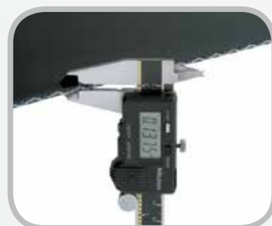
ベルト厚を測定します。
