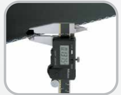
ベルト厚を測定します。
