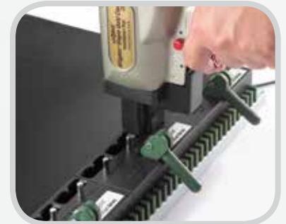
초기 드라이브 베이스: 간단하게 트리거를 당겨 벨트를 통해 사전 장착된 스테이플이 구동되는 초기 드라이브 베이스에 패스너와 벨트가 삽입됩니다.
