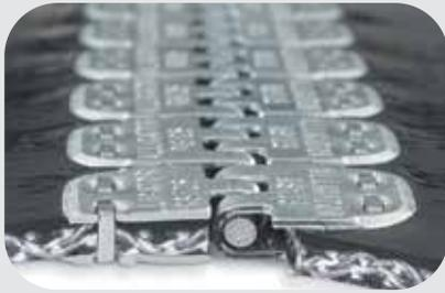
Alligator® 스테이플 패스너는 확장된 플레이트 디자인과 더불어 높은 인장력, 스테인리스 스테이플 부착력을 활용하며, 경량 및 중량급 합성 카카스 벨트에 맞게 설계되었습니다. 이 설계는 벨트 부착 포인트에서 스프라이스 약화를 해소하기 위해 벨트 굴곡 라인에서 패스너 관통 포인트를 분리합니다.
