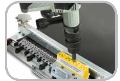
电动铆钉钻安装
