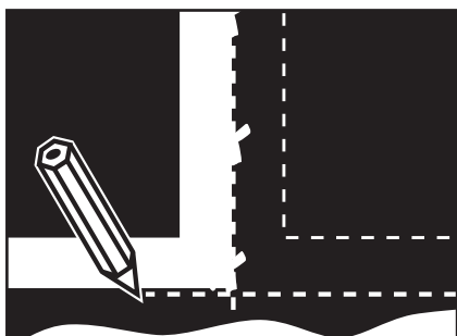
Se escuadra la banda utilizando el método de línea central.
